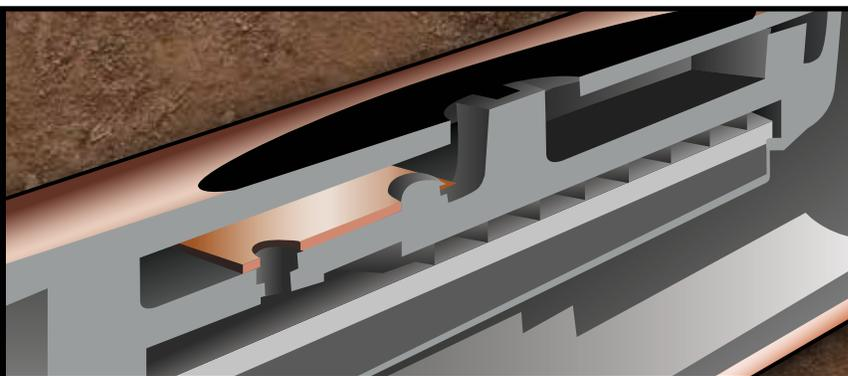
I gocciolatori XFS sono protetti dall'intrusione delle radici grazie alla tecnologia brevettata Rain Bird Copper Shield; si tratta di un sistema senza manutenzione o sostituzione delle sostanze chimiche atte a prevenire l'intrusione. Il color rame all'esterno indica la presenza della placchetta interna in rame.
